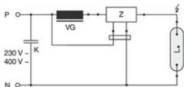
Circuit standard pour lampes capables d'être allumées à chaud 230V
