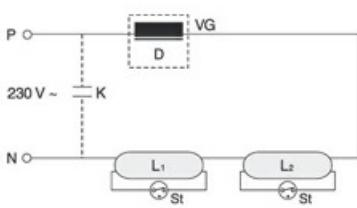
Circuit en tandem ou en série avec BC à puissance réduite
