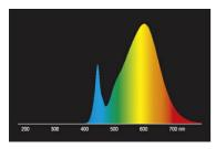
Lampes Led Retrofit standard en remplacement des 40W, 2700K
