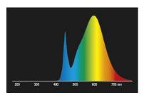
LED-Retrofit-Tube-Lampen für Leuchtstofflampen 3000K
