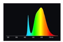
LED-Retrofit-Tube-Lampen für Leuchtstofflampen 4000K
