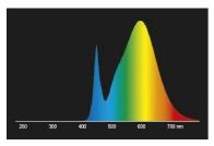
LED-Retrofit-Tube-Lampen für Leuchtstofflampen 3000K
