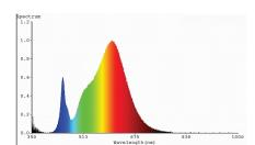
LED-Retrofit-Tube-Lampen für Leuchtstofflampen 3000K
